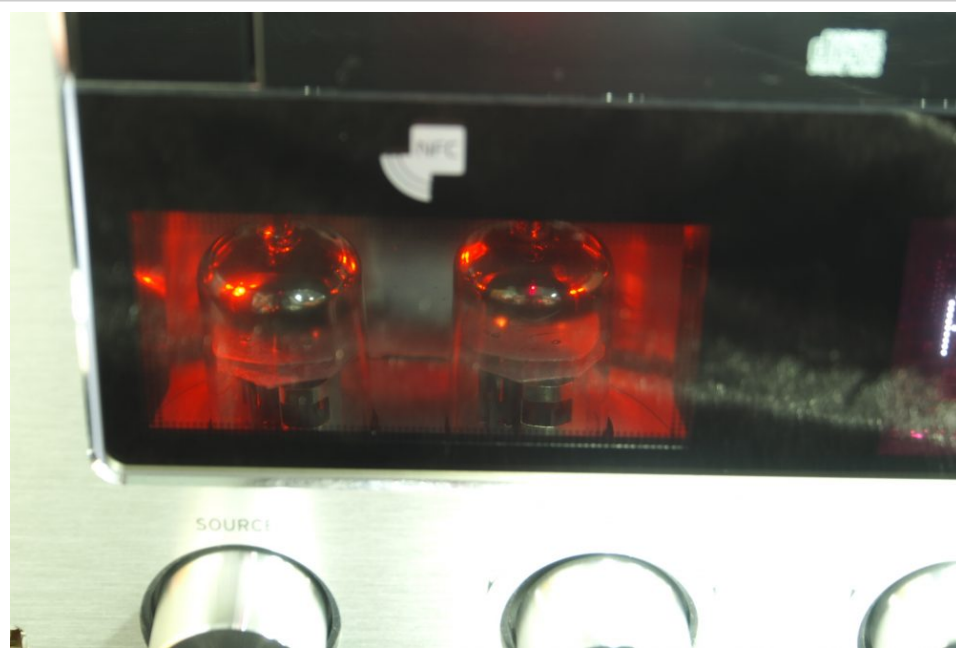
採用膽管前級放大，面板更有大窗口看到膽管運作。
